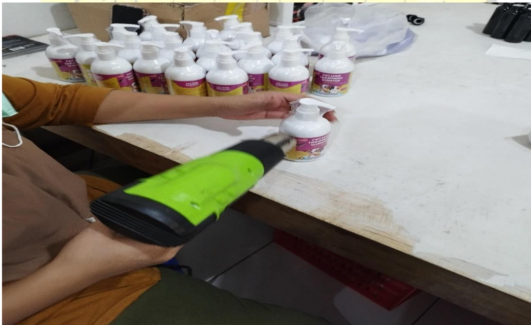
f. Proses pengemasan produk menggunakan hot gun
